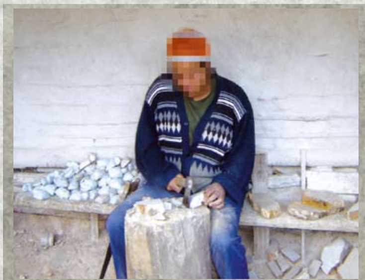
Imagem 18 - Conformação manual da peça com machadinha. Ver página 172. (Foto: Equipe PROSUL – CETEM/MCT)
