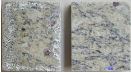
Figura 6 – Cristalização de sais nas bordas e nos cantos, preferencialmente sobre biotita.
