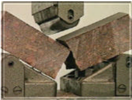
FIGURA 3 – Detalhe de corpo-de-prova rompido por aplicação de esforços flexores.
