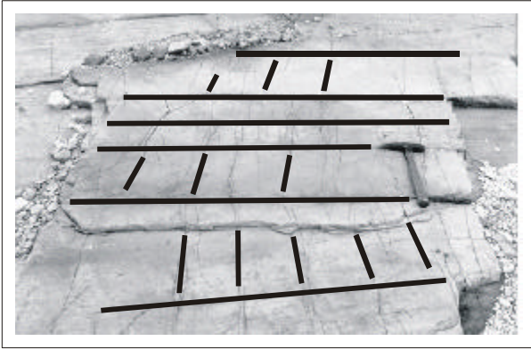
Fotografia 05: Padrão de fraturamento com espaçamento variável nas pedreiras de quartzitos do Centro Produtor de São Thomé das Letras na região de São Thomé das Letras (MG).
