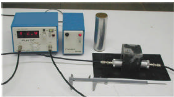
FIGURA 7 – Ilustração da medida de velocidade de propagação de ondas.
