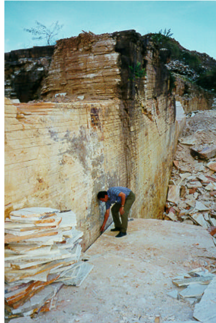
Figura 8 – Bloco grande, de forma geométrica bem definida, que foi obtido com a elaboração de um “plano de fogo” adequado.
