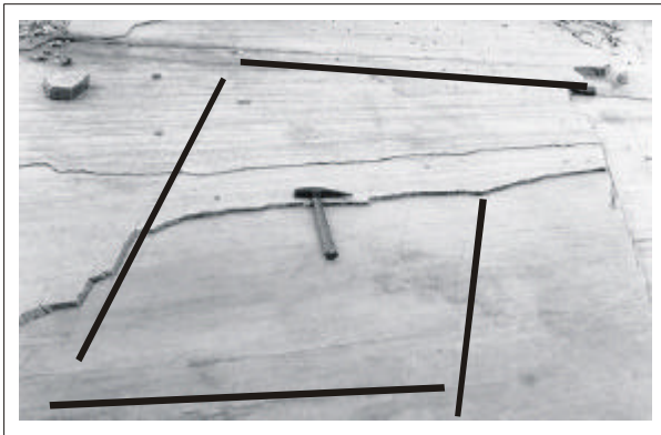
Fotografia 06: Espaçamento métrico entre fraturas nas pedreiras de quartzitos do Centro Produtor de São Thomé das Letras.
