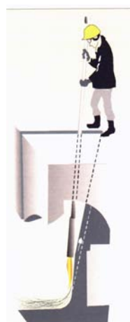
Figura 5: Corte com “Flame-Jet” Fonte: Vidal (1995)
