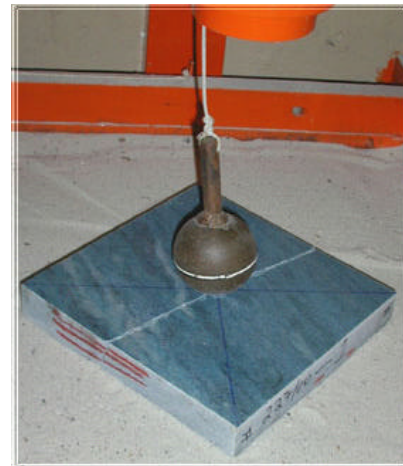
FIGURA 5 – Detalhe de corpo-de-prova quebrado pela queda de esfera de aço.
