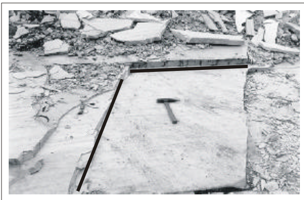
Fotografia 08: Família de fratura 03 nos quartzitos do Centro Produtor de São Thomé das Letras na região de São Thomé das Letras (MG).
