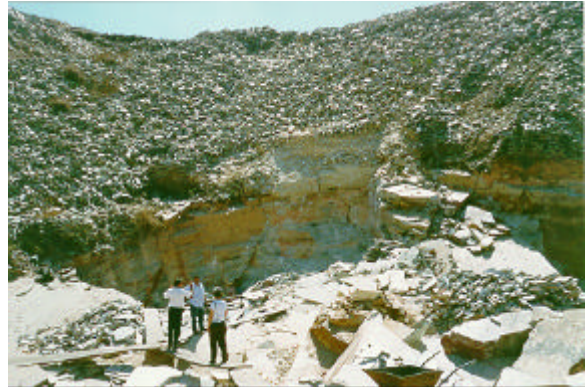
Figura 3 – Rejeitos da lavra depositados em cima da rocha que ainda vai ser desmontada.
