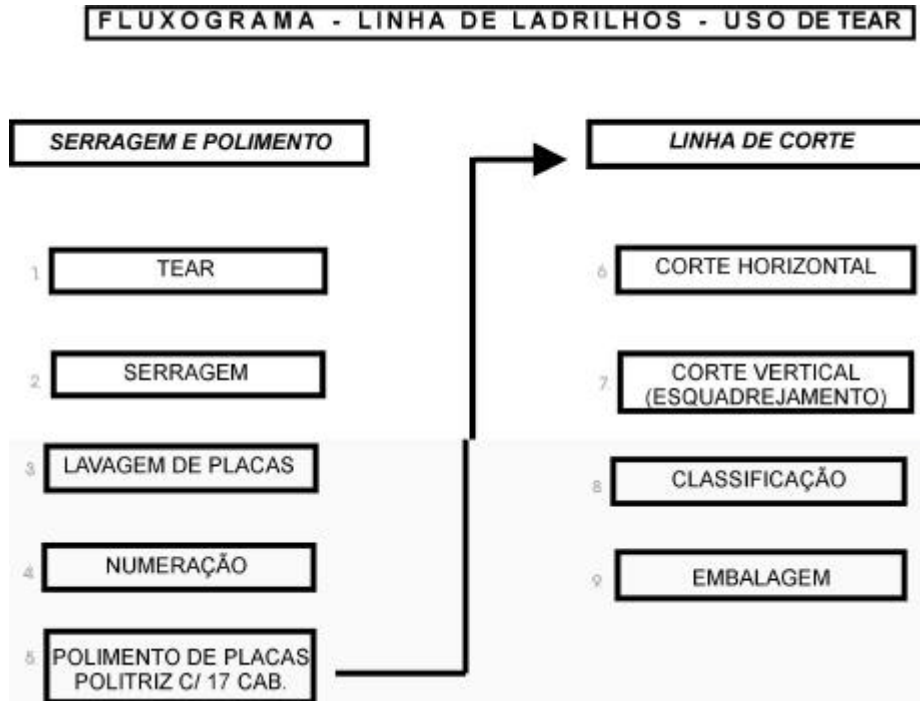
FIGURA 1 – FLUXOGRAMA GERAL DE PRODUÇÃO DE EMPRESAS CEARENSES – LINHA DE LADRILHOS COM USO DE TEAR.
