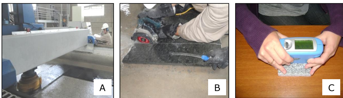
Figura 2. Etapas realizadas na pesquisa: (A) acompanhamento das etapas de polimento; (B) preparação dos corpos de prova; (C) medição do brilho.
