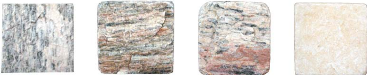
Figura 5 – Peça apenas cortada, anticatos obtidos com areia fina e areia para construção civil e peça utilizada como padrão (Anticato SUNNY TUMBELD, origem Índia).
