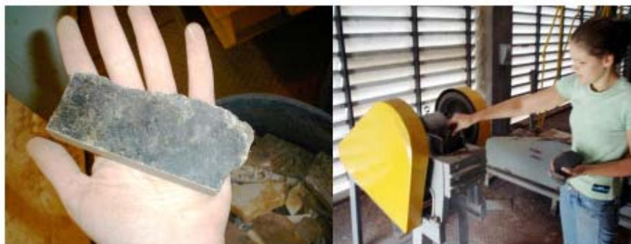
Figura 4- Rejeito de charnokito e britador de mandíbulas utilizado para fragmentar os rejeitos.
