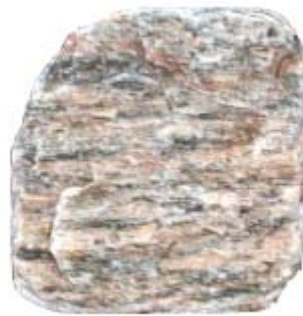
Figura 6 – Desgaste excessivo da peça de pedra Madeira, para um tempo de residência de 2 h no moinho.
