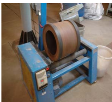
Figura 3 – Moinho utilizado na produção de anticatos.
