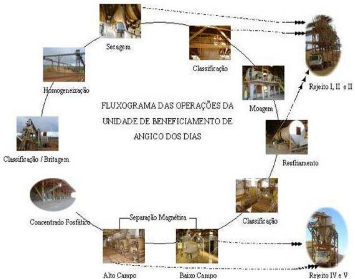
Figura 4. Fluxograma simplificado do processo de obtenção de concentrados fosfáticos – fonte Galvani
