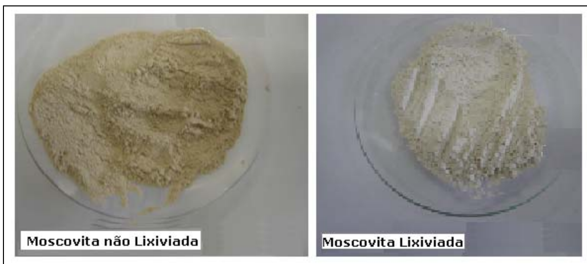
Figura 2 – Amostras de moscovita não lixiviada e após a lixiviação.
