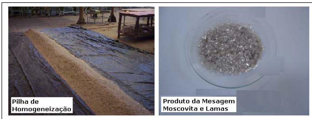
Figura 1 – Pilha de homogeneização com a mostra original e o produto da mesagem, isto é, moscovita mais lamas.
