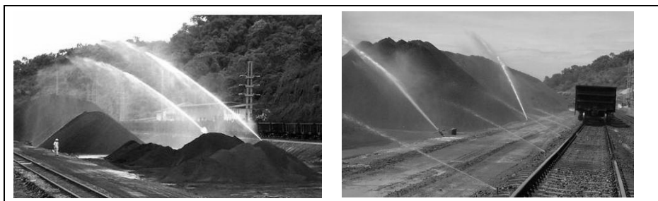
Figura 6 – Irrigadores com aspersores de água em pilhas de minérios.
