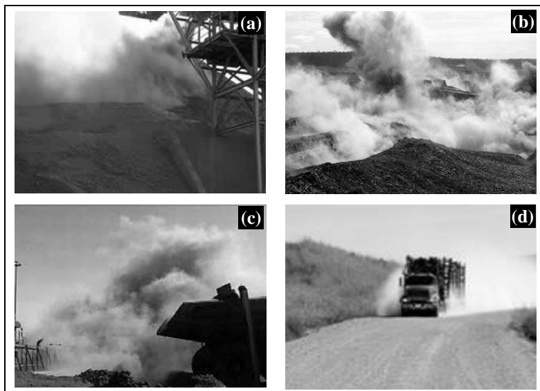
Figura 3 – Atividades da mineração com conseqüente geração de poeiras. (a) Ponto de transferência de minério de ferro; (b) Explosão em uma mina de carvão; (c) Transporte e formação de pilhas de carvão; (d) Transporte em estradas não pavimentadas.
