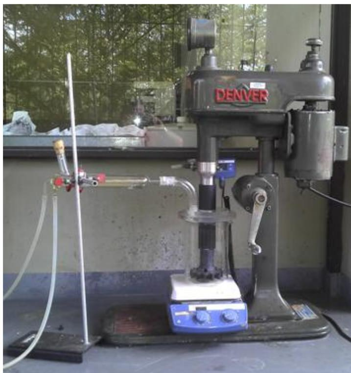
Figura 1: Célula Denver modificada empregada nos ensaios de lixiviação atmosférica.
